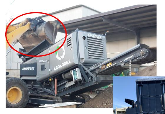
THE REAR TILT HOPPER IS MOVE BY REMOTE CONTROL
